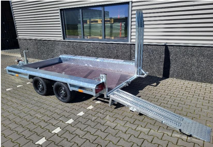
Vlemmix verschuifbare oprijplatenlengte 165cm 101.009.xxx Vloerhouderring gemonteerd. 321.001.116 Graafbak plateau, zonder kist 101.009.007 Kokers en roosters zijn 60mm i.p.v. 40mm. Roosters zijn smaller dus meer verticaal draagvermogen. Hier is geen meerprijs ten opzichte van de standaard klep.
