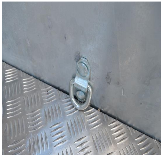
Vlemmix verschuifbare oprijplatenlengte 165cm 101.009.xxx Vloerhouderring gemonteerd. 321.001.116 Graafbak plateau, zonder kist 101.009.007 Kokers en roosters zijn 60mm i.p.v. 40mm. Roosters zijn smaller dus meer verticaal draagvermogen. Hier is geen meerprijs ten opzichte van de standaard klep.
